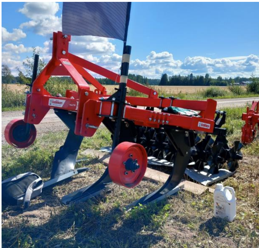
Jankkuri poistetaan tiivistymiä
